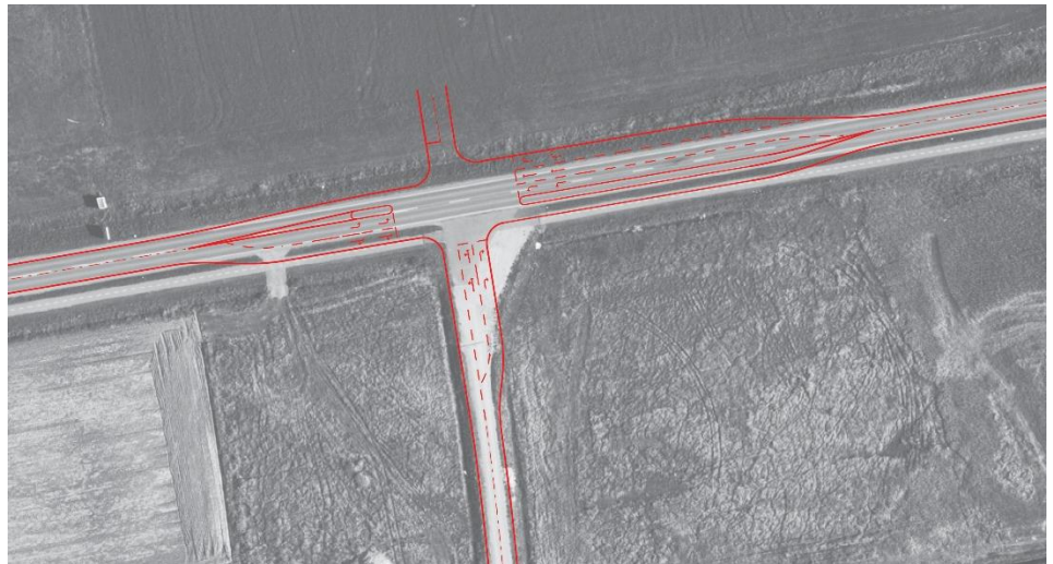
Figur 43 - Illustration af firebenet kryds som tilslutning til Søndervig Landevej.
