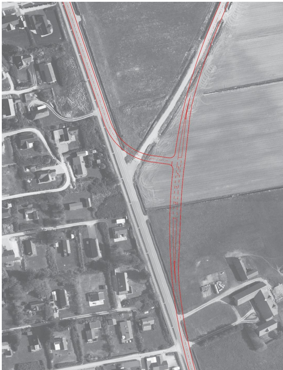
Figur 34 – Illustration der viser princip for den nye omfartsvej til Holmsland Klitvej, hvor trafikken mellem syd og øst er prioriteret.
