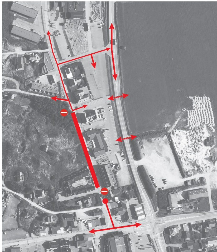
Figur 14 - Oversigtskort der viser udstrækningen af lukningen samt det afledte trafikflow via "forbindelsesvejen". De stiplede pile angiver eventuelle direkte overkørsler til Houvig Klitvej fra parkeringsarealerne for at kompensere for den manglende adgang fra Lodbergsvej.
