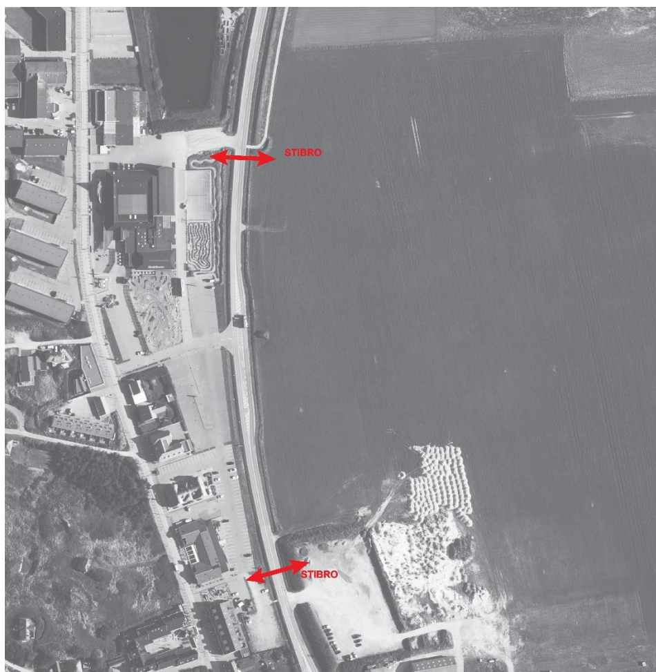
Figur 29 - Illustration af princip for placering af fodgængerbroer.
