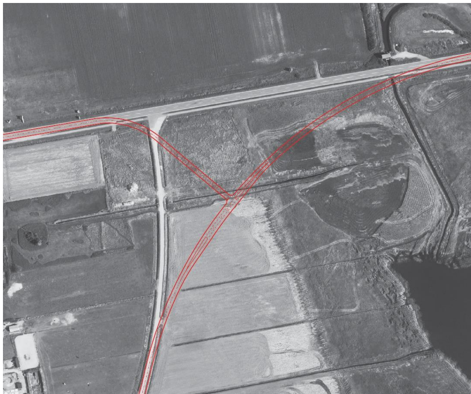
Figur 35 - Illustration der viser princip for den nye omfartsvej til Søndervig Landevej, hvor trafikken mellem syd og øst er prioriteret.
